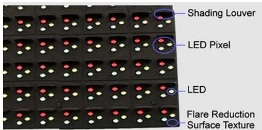
Fig. 2: LED Display Module.
