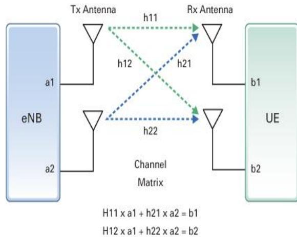
**Fig. 1.3: 2X2 MIMO Channel**
